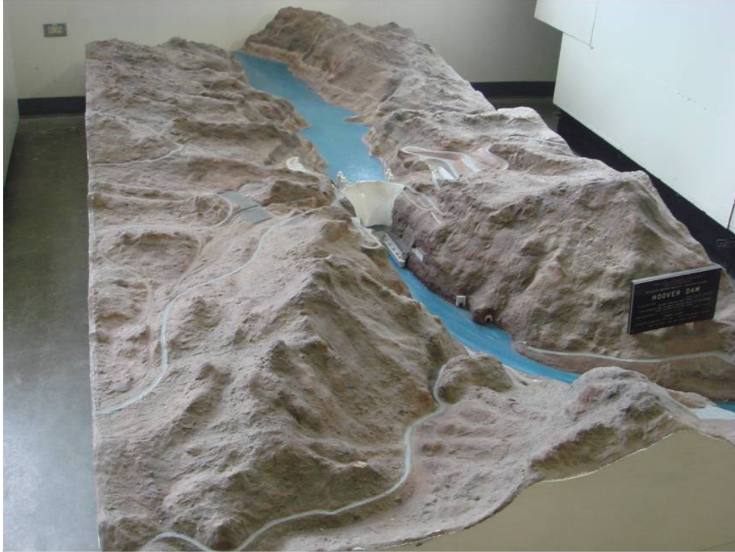
照片 3-5 胡佛水庫之水工模型
