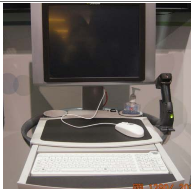
具乾洗手液、條碼掃描機與鍵盤之工作車檯面，鍵盤採用可以沖洗的橡膠材質
