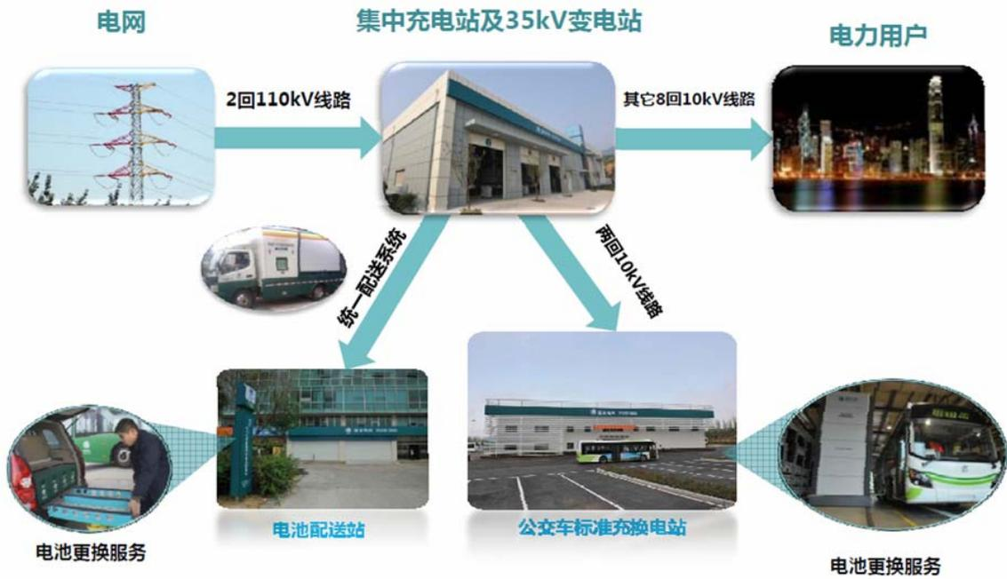
圖 27 薛家島電動汽車示範充換電站架構圖
