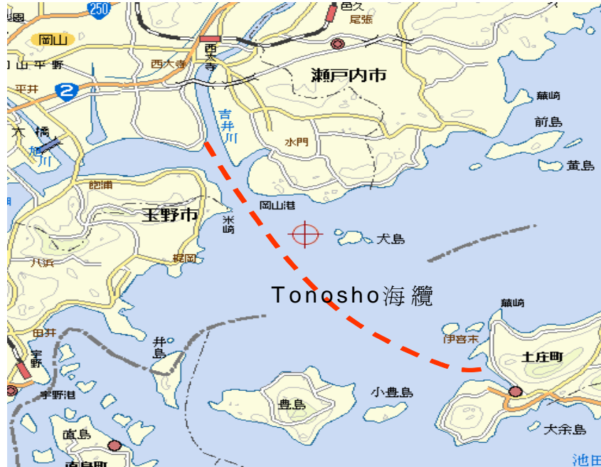
圖 20 瀨戶內海小豆島 AC66KV 海底電纜
