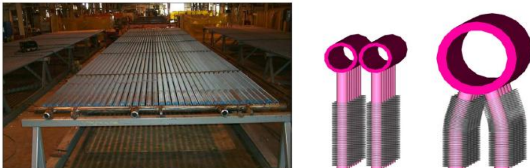
圖3-12 HRSG傳統與OCC™設計比較【17】
