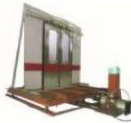
牽引システム振動傾斜試験装置
