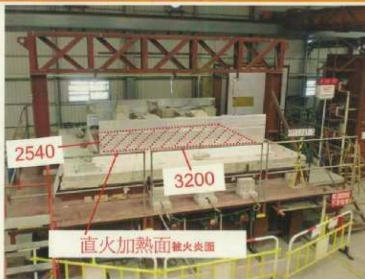
測試樣品設置照片 試驗体設置写真
