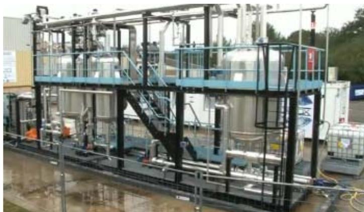
圖十五 法國 INNOVEOX 公司 100kg/h 產量的先導型量產工廠
