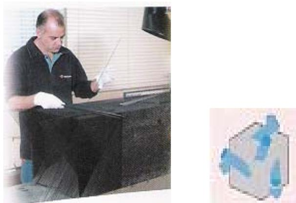
圖三 該公司人員正在進行四維碳/碳複合材料預成型體製作(左)；四維編織法示意圖(右)
