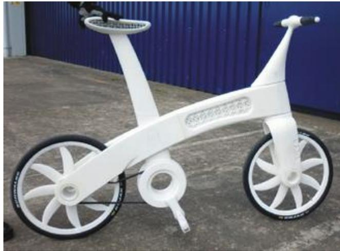
圖十 歐洲航空研發的超堅硬尼龍自行車(Airbike)
