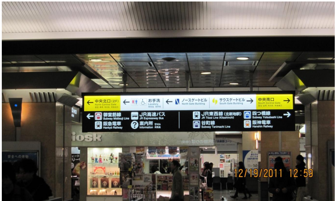
圖 4-4 新大阪站指標係依 sign manual 設置,顏色對比明顯,圖例淺顯易懂,於交通量較繁忙或觀光客較多之車站還會有中、英、韓文之附註。
