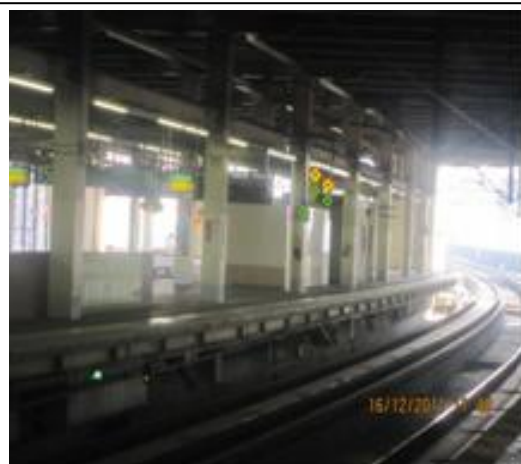
圖 4-106 (大宮車站)就新幹線所用列車停止標識(因列車高低不同，此上、下不同標識，方便機員辨視)。
