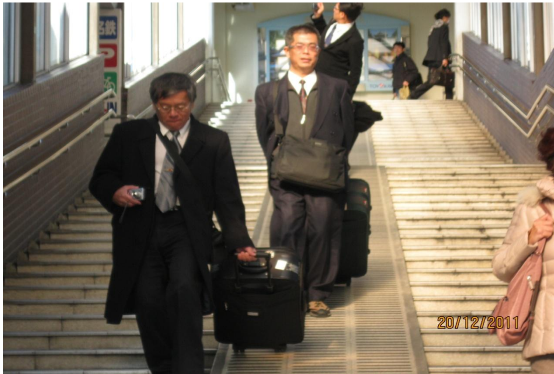
圖 4-12 另於名鐵線國府車站，因該車站規模沒很大，未設置電梯，僅於樓梯中間設置無障礙斜坡道，攜帶大件行李旅客出入沒問題，但如果是乘座輪椅的旅客可能就需要站務人員協助了。
