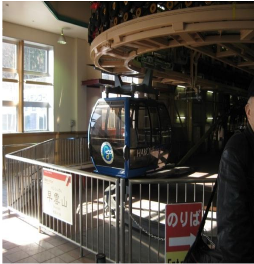
圖 6-12 高空纜車每架荷重可達 1920 公斤約 24 人次,因纜車尺寸較大且載客量較多,採雙纜線吊掛設計,乘坐品質平穩舒適,因纜車可快速將旅客由低海拔處運送至高海拔處,阿里山易坍方處,如地質許可建議可將部分路段改以纜車運輸,除較安全快速外,還可欣賞不同景觀。
