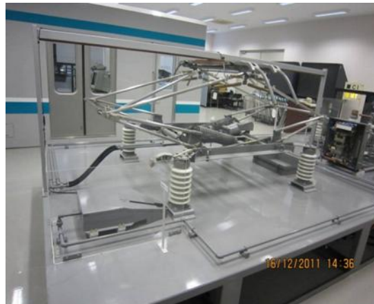
圖 5-8 集電弓構造及原理講解、實際操作
