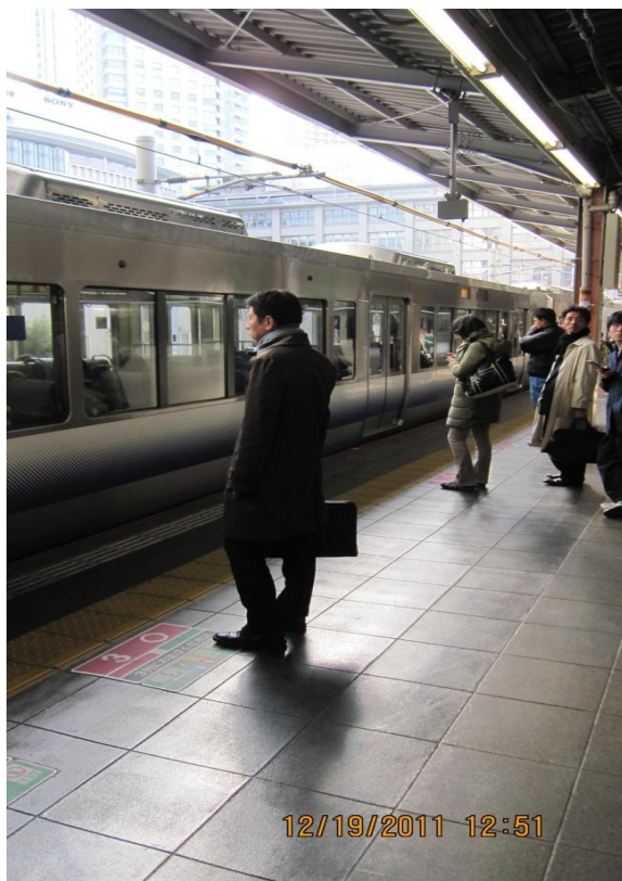
圖 4-7 爲了讓乘車旅客有更舒服的乘車候車環境,月台上的指標已盡量簡化,甚至於將不同長度列車的停車位置標示於地上,避免指標太多不易辨識。另爲避免強風吹襲,月台上之看板、號誌或指標均有利用鋼索拉住,以維安全。
