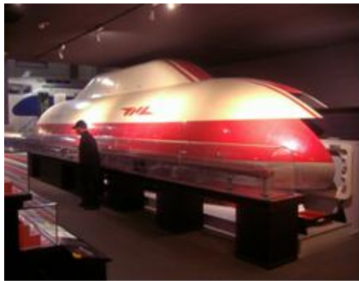
圖 7-6 鐵道未來展示區，展示搭載超導電磁石的 ML500 型列車，在宮崎實驗線測試時創下時速高達 517km 紀錄。
