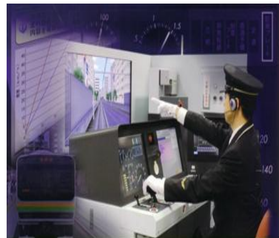
圖 5-15 司機員訓練以駕駛員模擬機模擬實際狀況，訓練司機員實務駕駛及臨場反應狀況。
