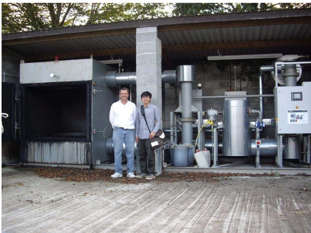
圖 9. 芒草製炭之熱裂解爐設備。
