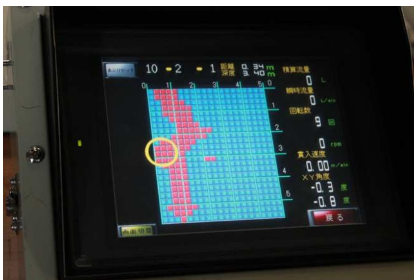
圖 3、WILL 工法地下攪拌結果的顯示螢幕
