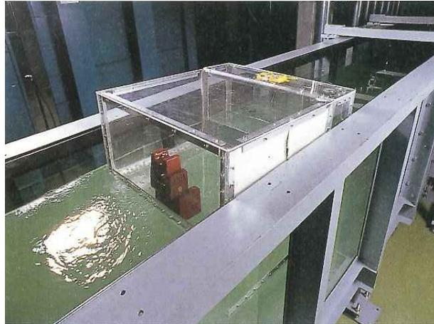
圖 10 關鍵元件熱交換版 圖 11 波浪發電實驗設施
