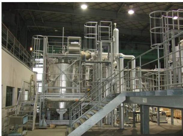
圖 8 溫差發電除氣設備
