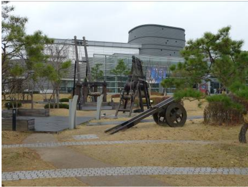
圖 54：水原歷史博物館展示復原之水原華城建城石材吊架
