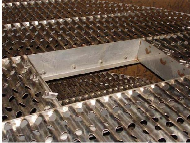
圖一 新式波形塔盤(Ripple Tray)
