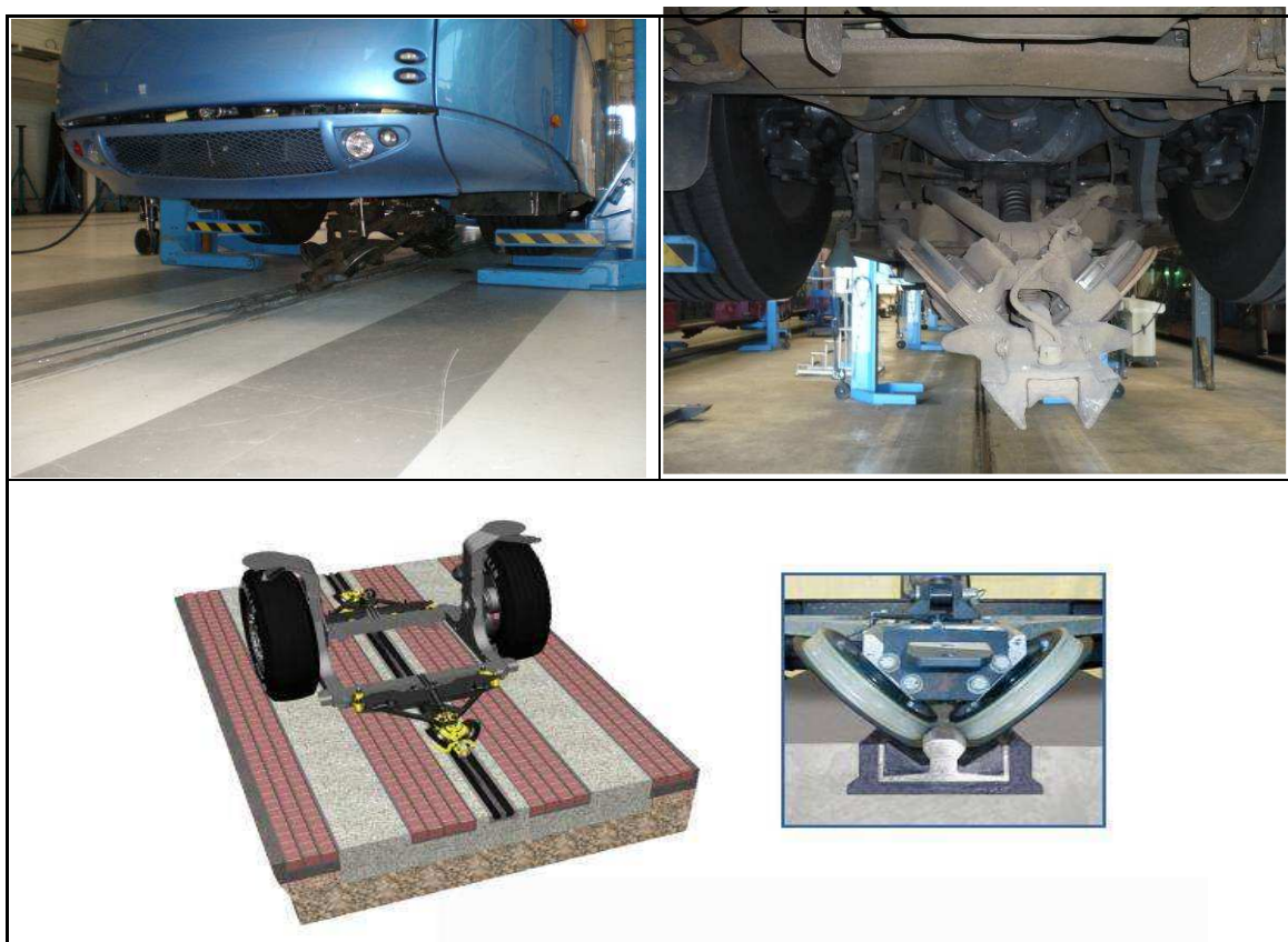
圖 3.4-4 克萊蒙費朗輕軌之導軌原理示意圖
