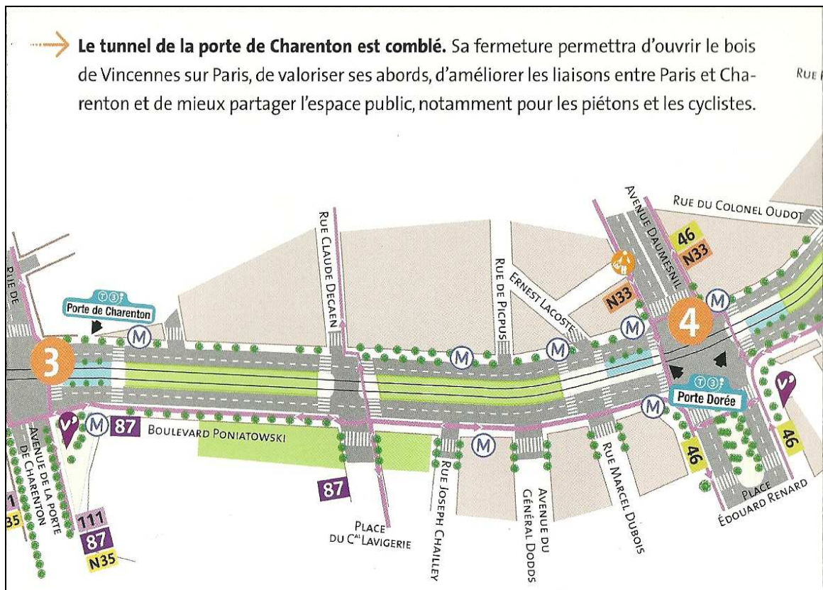
圖 3.6-5 巴黎 T3 線延伸段道路空間調整示意圖
