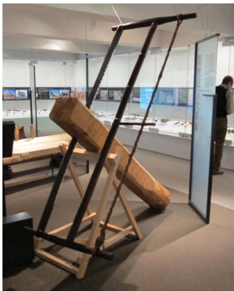
鋸出大片版材所使用的大鋸，需要兩個人同時一拉一推。
