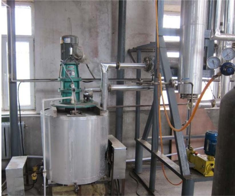
圖 5：三劑化工小型 MtG 技術試驗裝置的甲醇進料熔鹽加熱設備
