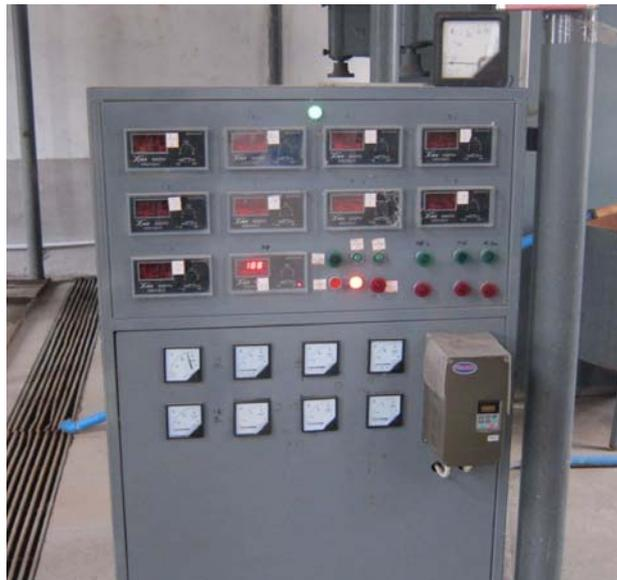
圖 6：三劑化工小型 MtG 技術試驗裝置的控制儀表設備
