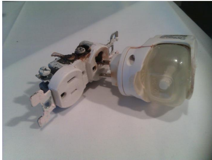
照片 58：課程中所展示的接觸不良引發電弧的再現實驗
