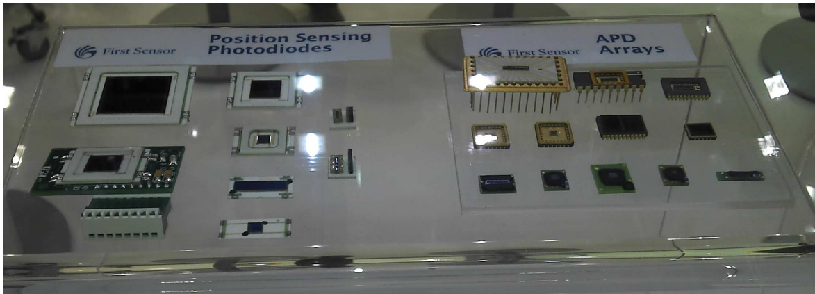
圖五、First Sensor 公司生產之 APD 相關感測器。
