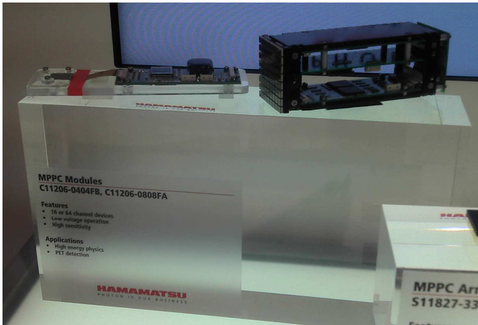
圖四、日本 Hamamatsu 公司新推出 8x8 通道的 MPPC 陣列模組。
