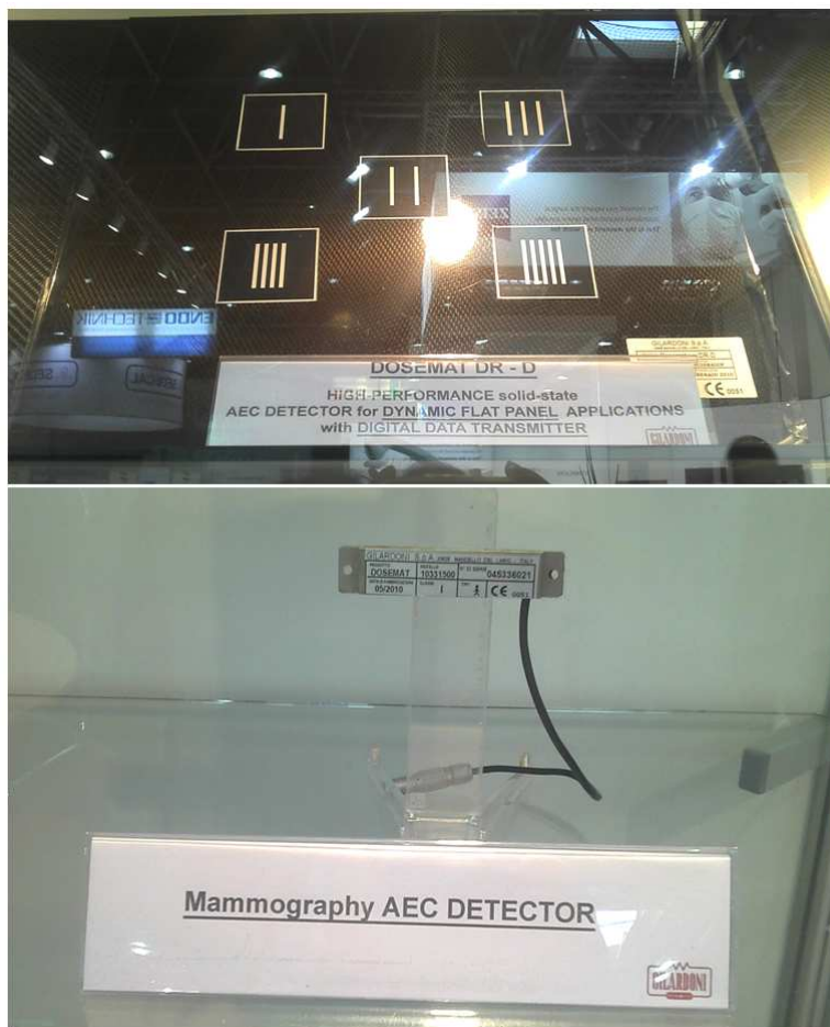
圖六、GILARDONI 公司的自動曝露控制 AEC 組件。
