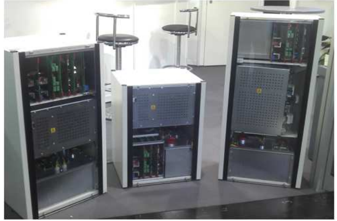
圖七、K&S Röntgenwerk 公司 X-光操作面板(左圖)；X-光高壓產生器(右圖)。
