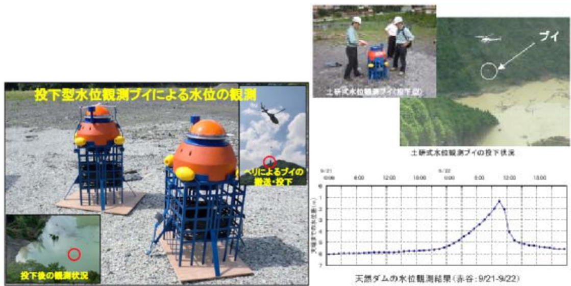
圖 5 日本土木研究所研發的投入式水位觀測計(左)，並應用在赤谷地區堰塞湖的水位觀測(右)。
