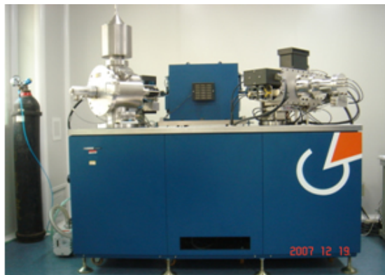
圖 24. 熱電離質譜儀，主要用於鈾、鉛、鈾、鈷、鉀、鋇、鋅、鋁的同位素分析
