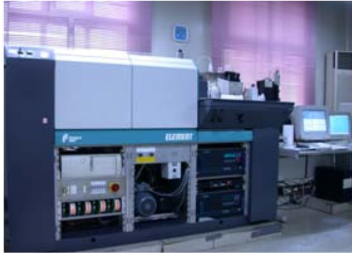
圖 18. 高分辨電感耦合等離子體質譜儀 主要用於鋰-鈾元素與同位素分析
