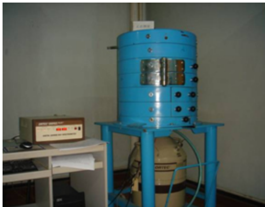
圖 22. 高純鍺 \gamma 能譜儀 主要用於鈯、鈾、釷、鐳的 \gamma 核素分析
