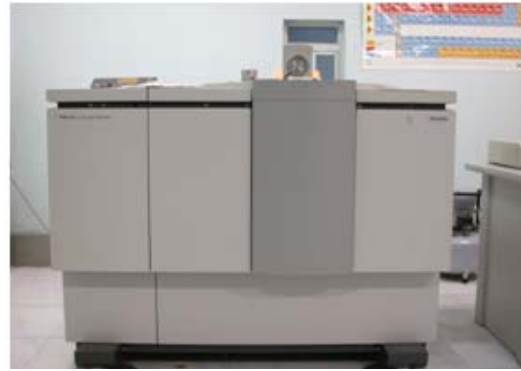
圖 19. PW2404 波長色散 X 射線螢光光譜儀 主要用於碳-鈾元素分析
