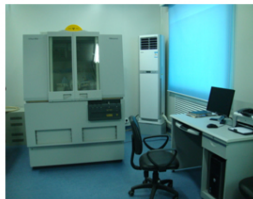
圖 23. X'Pert X 射線粉晶衍射儀 主要用於物相分析
