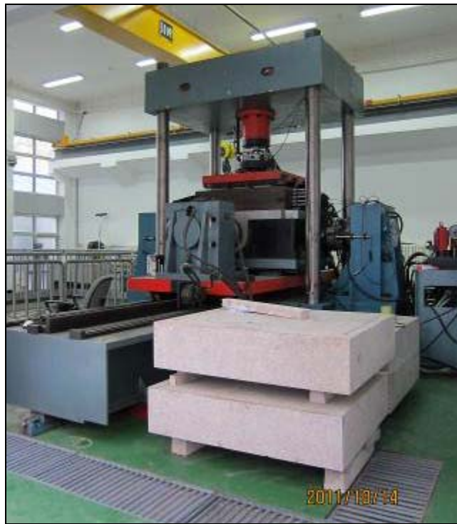
圖 15. 大尺度節理岩體透水試驗台
