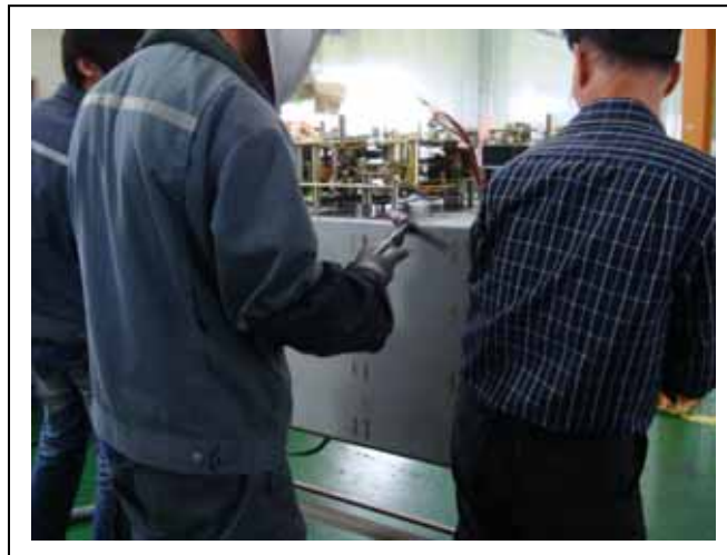
充填乾燥空氣，起泡劑檢測是否洩漏
