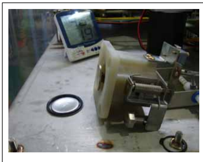
充填灌注 \text{SF}_6 至 0.6\text{kgf/cm}^2
