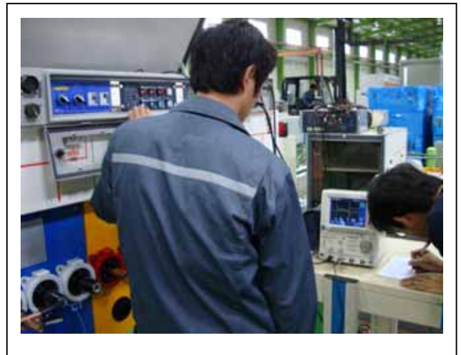
電動投入/切開，紀錄動作時間
