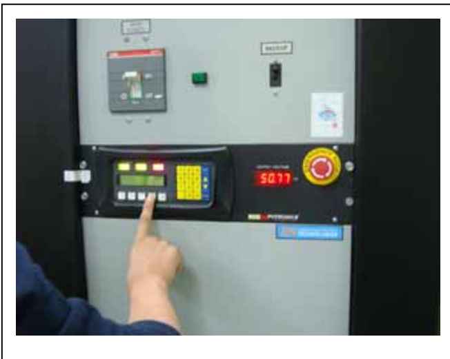
設定加壓電壓 50kV
