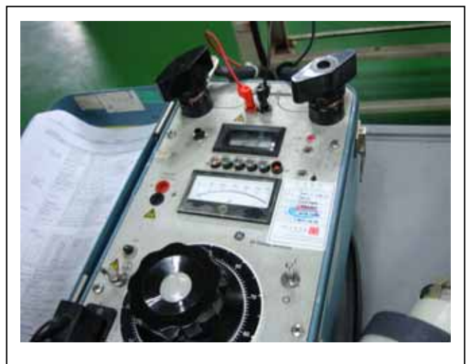
輸入 DC100A，量測接觸電阻
