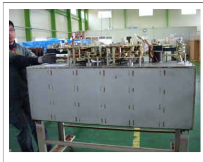
充填乾燥空氣，起泡劑檢測是否洩漏
