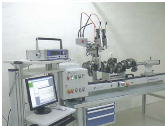
圖15 Stresstech公司Barkhausen雜訊偵測情形 (17) (a)、(b) 量測齒輪 (c) 硬度規塊 (d) 量測汽車曲柄軸
