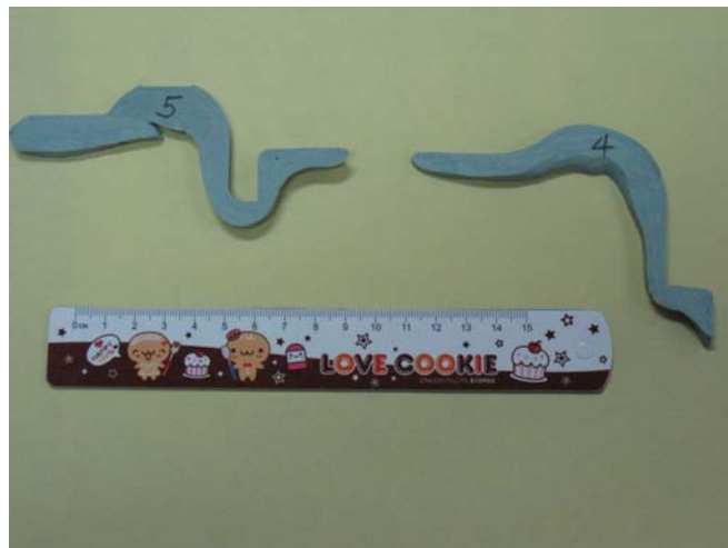
圖12 高/中壓轉子高溫區複製模照片 (a) 兩汽封環之間及汽封環凹槽 (b) 衝擊段葉片底部近中壓#1級動葉 (c) 衝擊段葉片底部近高壓段及高壓#1級動葉前凹槽
