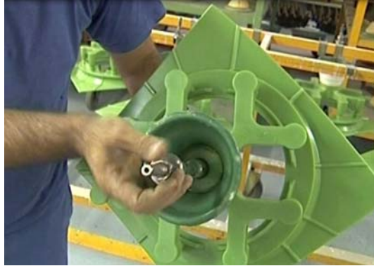
圖17 Microfusione Stellite公司組立蠟樹的情形 (21) (a) 置放蠟心 (b) 取出蠟模 (c) 組樹一例 (22) (d) 澆鑄頭固定吊掛頭
