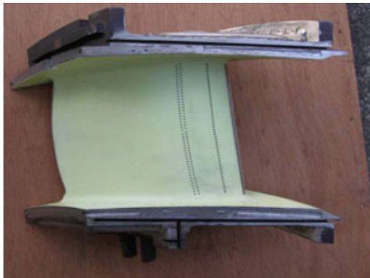
圖24 三菱公司M501F葉片照片 (24) (a)、(b) 第一級動葉片 (c)、(d) 第一級靜葉片
