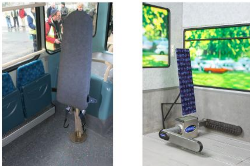
圖 3.3-20 輪椅固定設備例(左-QM3、右- Quantum)
