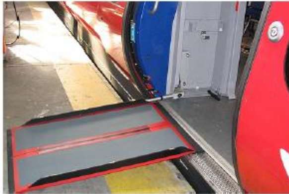
圖 3.3-12 收藏於車輛內之斜坡渡板(丹麥/DSB)
