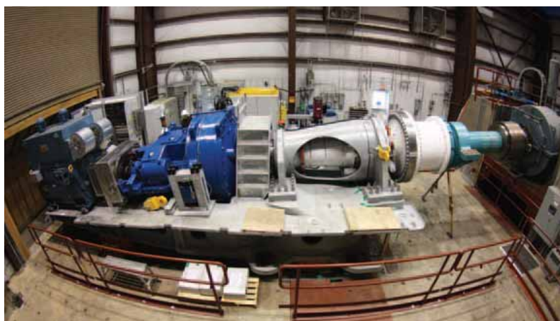
圖 6 NWTC 測試場動力計試驗 (Dynamometers 1kW-5MW) (節錄自 NWTC 網站)
