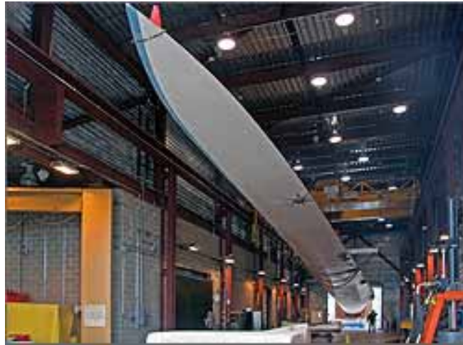
圖 7 NWTC 測試場大型風機扇葉疲勞試驗 (節錄自 NWTC 網站)
