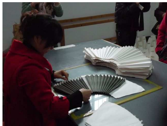
摺扇製作使用紙模折壓
