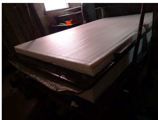
抄紙架提把是作為盪料入簾的主要施力處，抄製時紙架手把與合起，左右兩端的擋片壓住紙簾。
