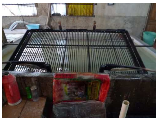
抄完架於可前後滾動的桿子上，再將掀開，手把向外開並連動翻開擋片，紙簾便可掀開
