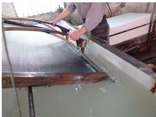
抄紙架提把是作為盪料入簾的主要施力處，抄製時紙架手把與合起，左右兩端的擋片壓住紙簾。
