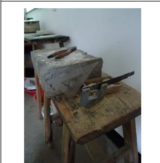
穿過細孔以鉗子抽拉成均勻細竹條
