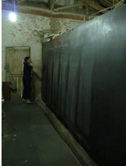
鐵牆不時要刷上稀漿糊水
