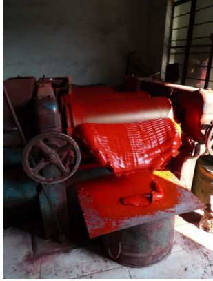
再經過機器式滾筒反覆壓滾
