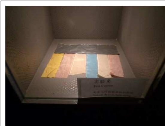
光老化對植物染料的影響試驗
