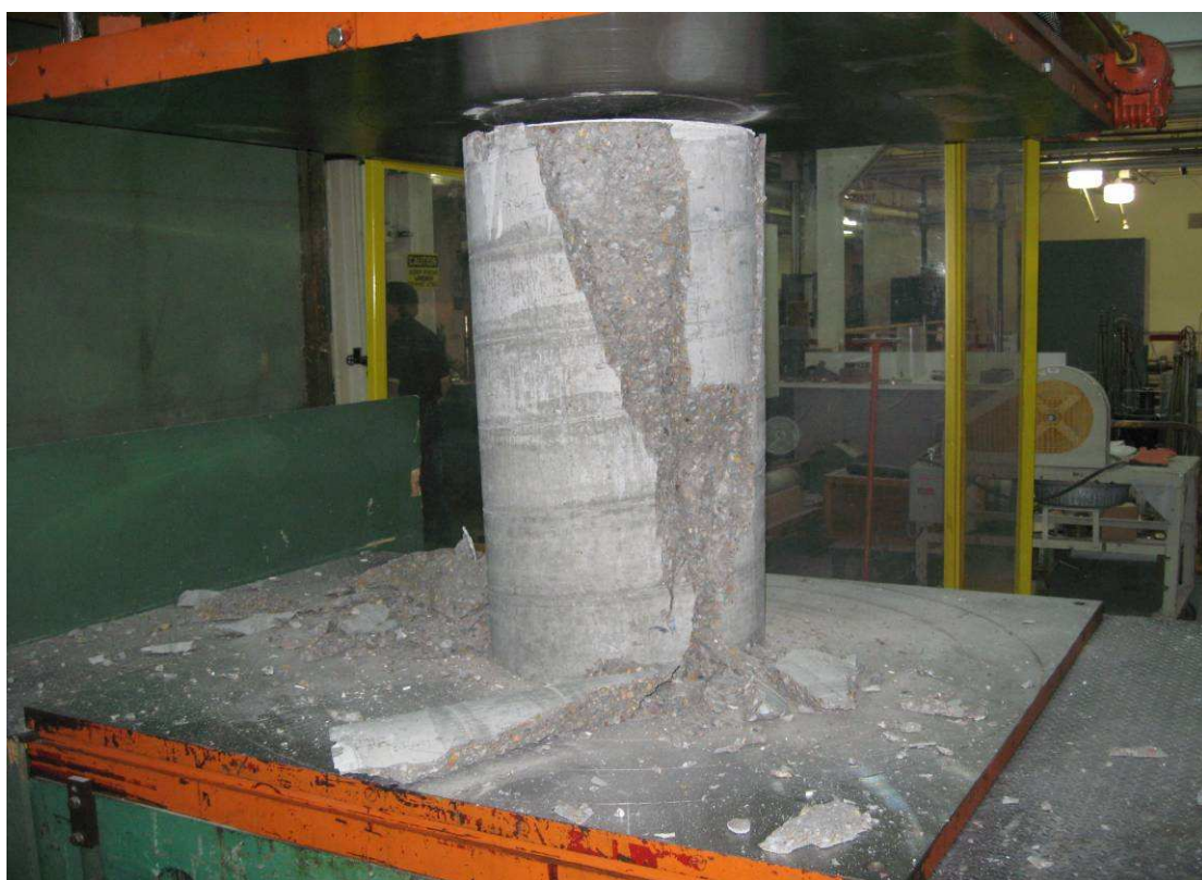
現場示範圓柱混凝土抗壓試驗
