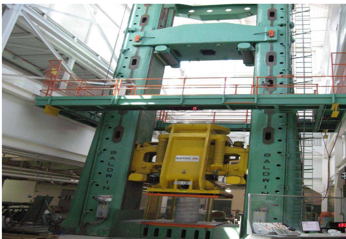
大型混凝土抗壓試驗設備
