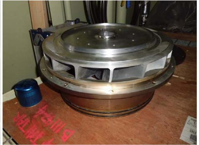
Emergency Shut Down Valve (VL-032) Valve Disc Damage(MHI 同意列為保固項目，先使用船上之配件更換，再向 MHI 求償), VL-022 & VG-072 Seat Ring Damage, Cargo Pump Discharge Valve for 4S Seat Ring Damage。
