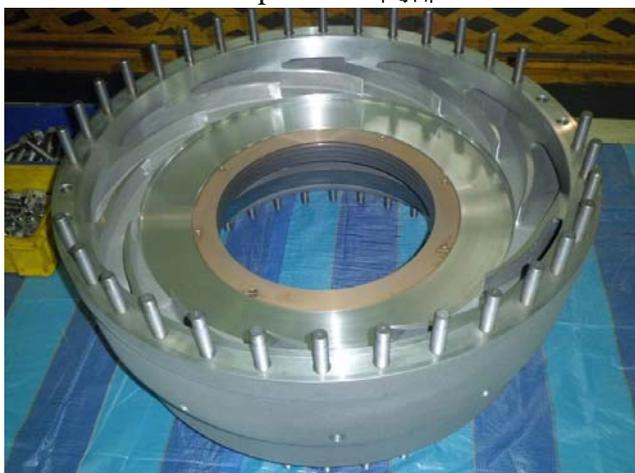
Pump 連結 Impeller 及 motor 部分
