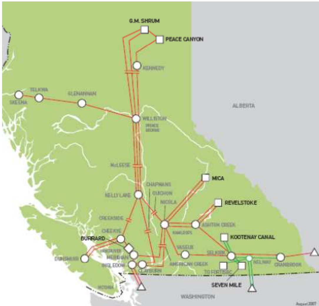
圖 6-1 整個 BC 省 500kV 幹線系統
