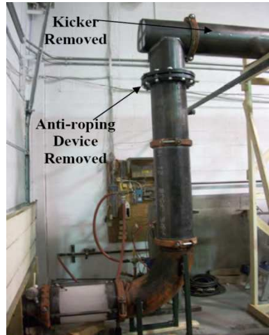
圖 3.3.4 Upflow 設備配置圖
