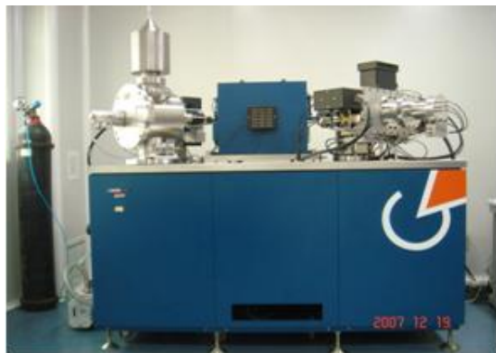
圖 24. 熱電離質譜儀，主要用於鈾、鉛、釷、鈾、鉀、銀、鋅、鋰的同位素分析
