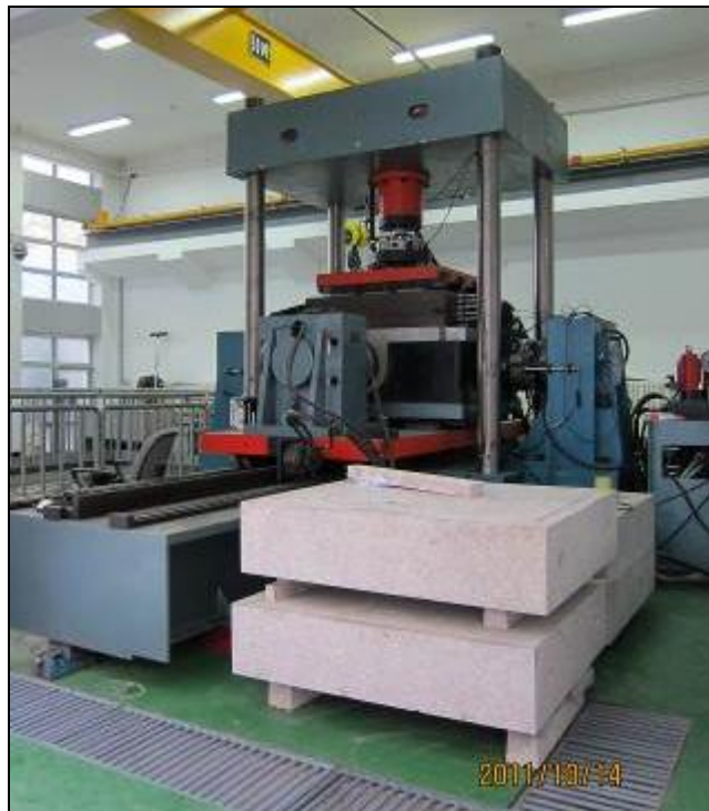
圖 15. 大尺度節理岩體透水試驗台
