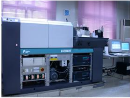
圖 18. 高分辨電感耦合等離子體質譜儀 主要用於鋰-鈾元素與同位素分析
