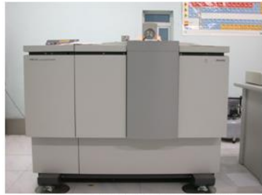
圖 19. PW2404 波長色散 X 射線螢光光譜儀 主要用於碳-鈾元素分析
