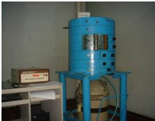
圖 22. 高純鍺 \gamma 能譜儀 主要用於鈯、鈾、鈷、鎘的 \gamma 核素分析
