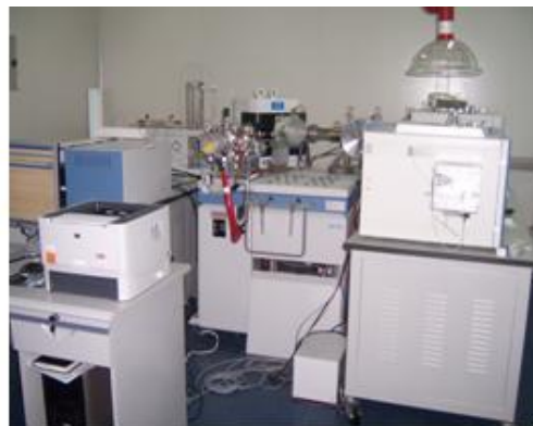
圖 25. MAT-253 氣體穩定同位素質譜儀 用於碳、氫、氧、硫、氮的同位素分析
