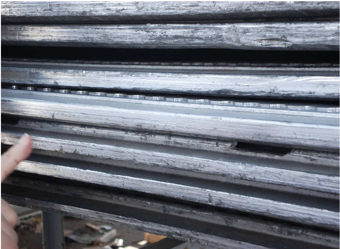
附圖三：檢查貨運倉庫，發現待使用之貨盤 PMC83092CI 多處 EDGE RAIL 損壞，立即予以隔離。
