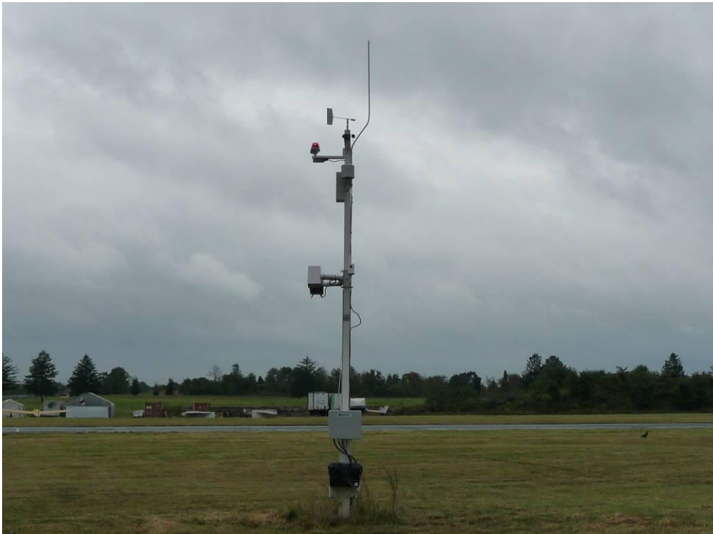
圖 8 機場即時天氣觀測裝備
