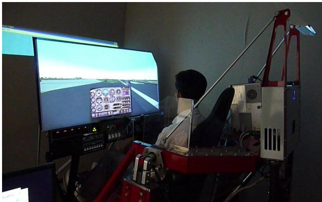
圖 26 全動感飛行模擬器 FD-301
