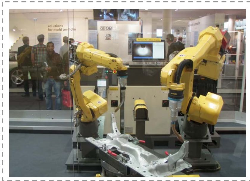
編號 7. 攝於 2011 年 9 月 22 日, 照片內容簡述: FANUC 公司開發之機器人線上量測系統
