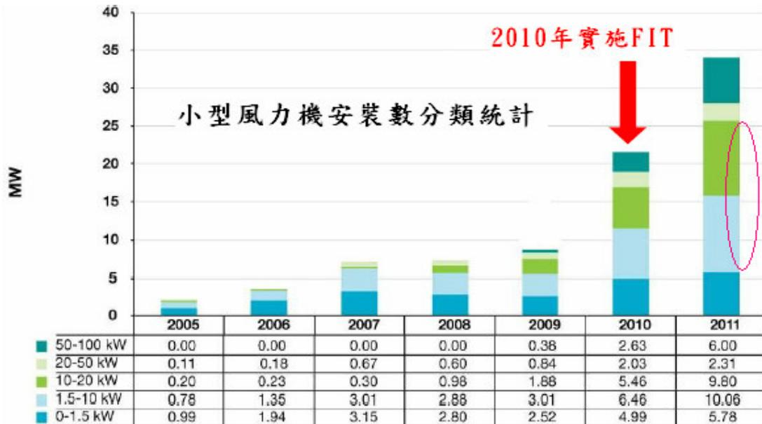
圖 4 2010 年實施 FIT 制度後安裝數大幅成長，其中以 1.5~20 kW 為主力產品
