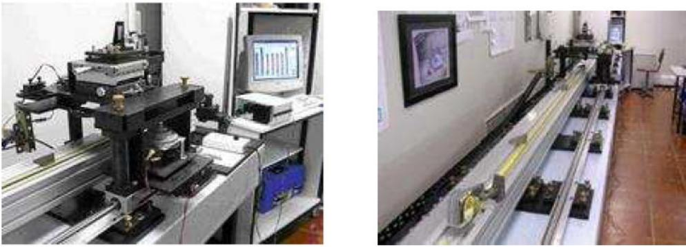
圖 14、直尺和 5 公尺捲尺測量系統
