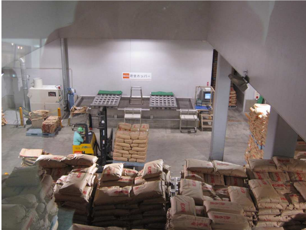
圖 16、パールライス安城工廠糙米進料（進料倉高於地面，以避免人員走動的灰塵混入）
