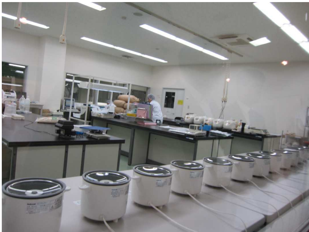
圖 19、パールライス安城工廠品管室，進行品質測試，及口感測試，品管室中有一整排小型炊飯機
