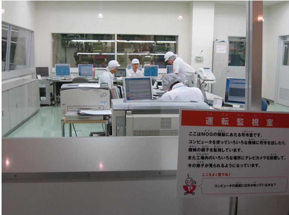
圖 18、パールライス安城工廠中央機房，以電腦監控所有設備運作及零件更換
