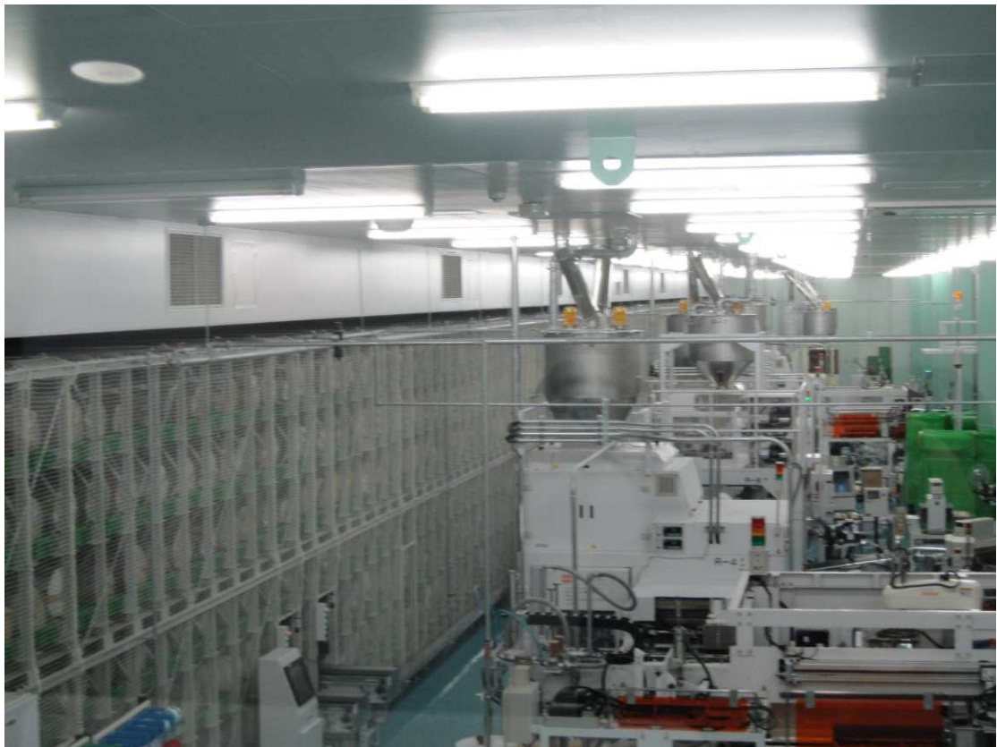
圖 19、パールライス安城工廠包裝室，所有包材以電腦及機械手臂控制，避免人為操作造成疏失
