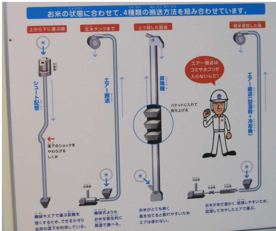
圖 15、パールライス安城工廠氣力輸送與機械輸送説明
