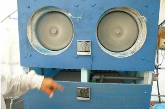
圖 10. 簡易式冷交換機，利用冷水流經散熱片與風扇的作用，組裝為降溫系統。
