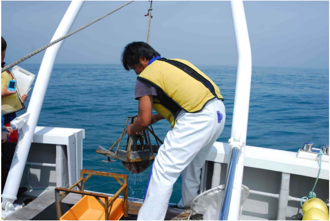
研究船上利用挖泥器採集底棲生物
