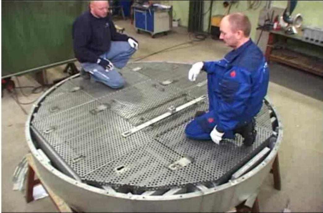
圖(二) Topsoe 新改進的分散盤為整排
