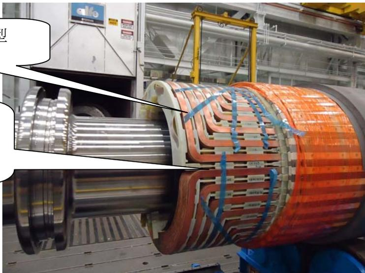
線圈末端通風導板，在導風板與轉子鐵心之間會加入 Ripple Spring 以加強固定力量
