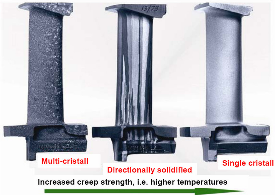
圖 10、利用冶金技術提高氣機葉片抗高溫的能力
