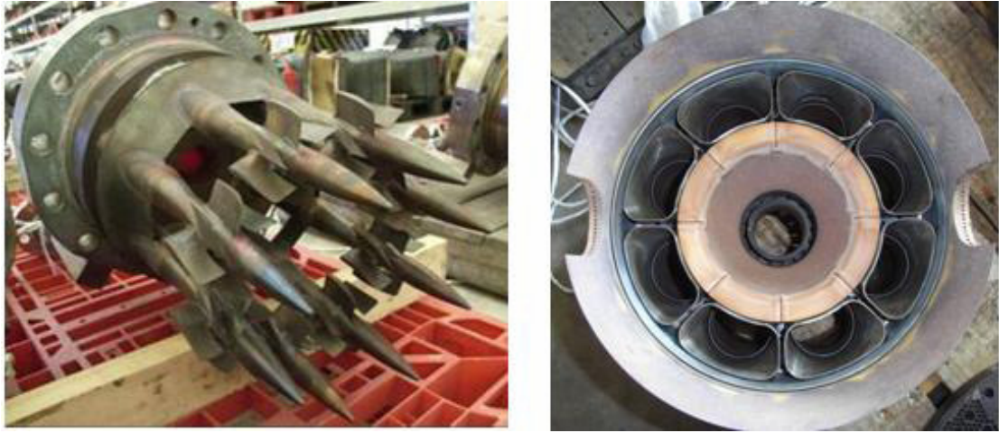
圖 53、DLN 燃燒氣的噴嘴和渦旋器
