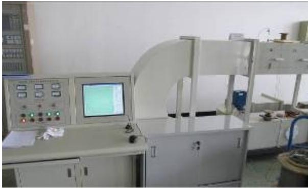
感溫火災探測器閾值檢測裝置
