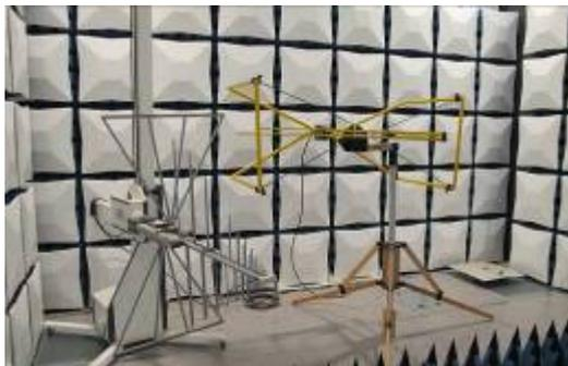
射頻電磁場輻射抗擾度試驗設備
