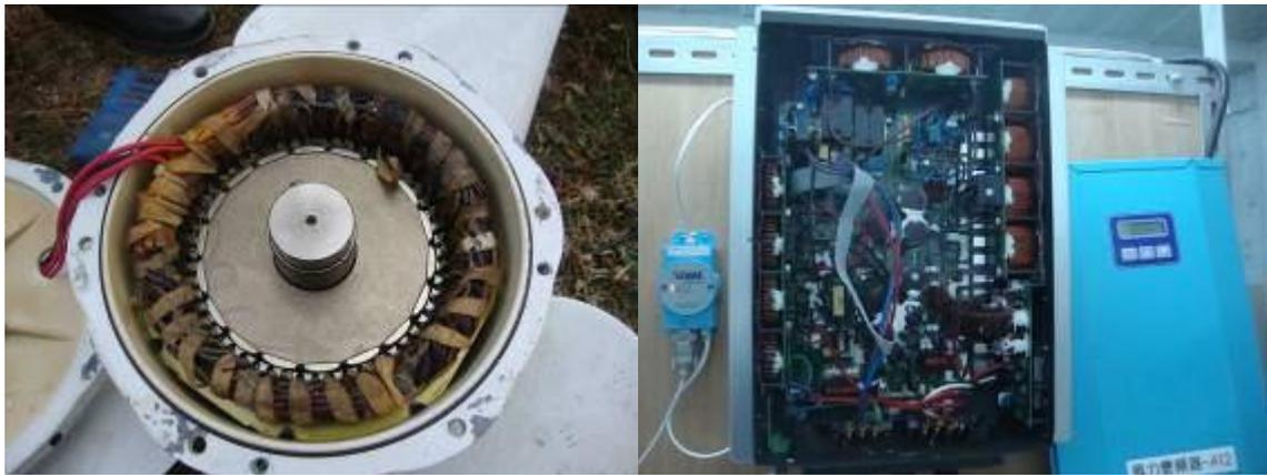
圖 2、彭科大 Wind Park 小型風機發電機與電控器損毀
