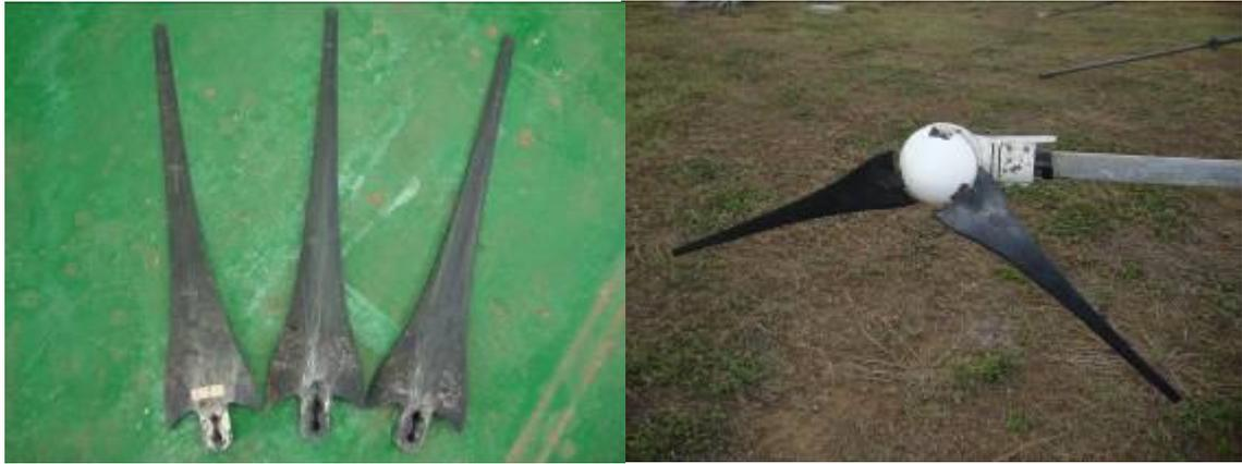
圖 1、彭科大 Wind Park 小型風機葉片斷裂
