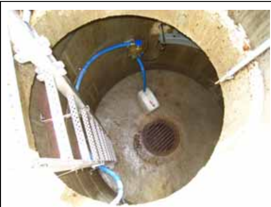
土壤入滲速率量測，係直接連結於測站下方，直接量測真實的土壤當時降雨入滲速率。
