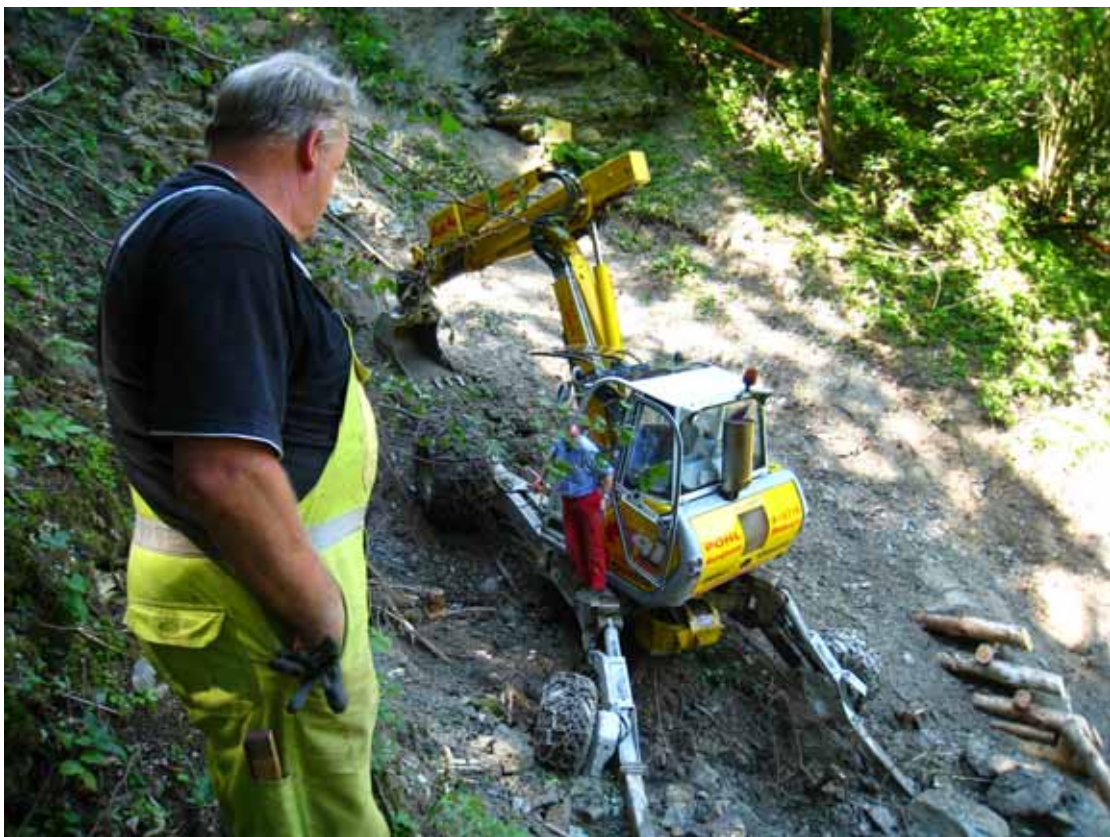
照片 13 可於坡地移動的特製機械（Menzi Muck）。
