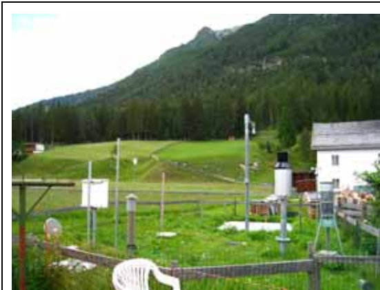
逕流預測之全自動觀測站，完整預測模式所需用到參數皆有相對應觀測儀器提供即時數據
