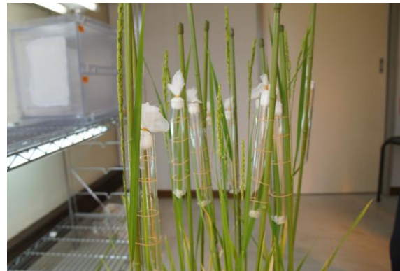
孕穗期接蟲於水稻劍葉進行抗飛蟲檢定情形
