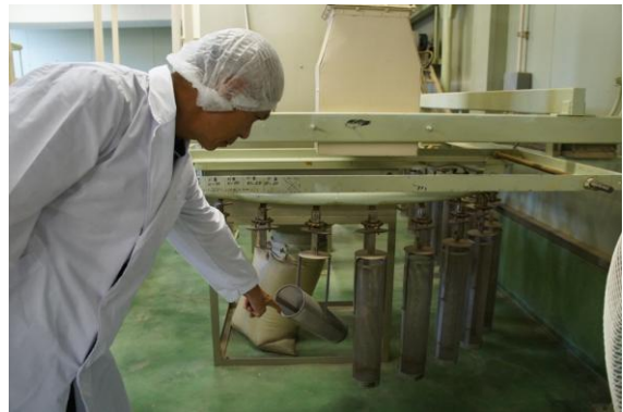
瓜實蠅蛹照射放射線的容器及輸送盤
