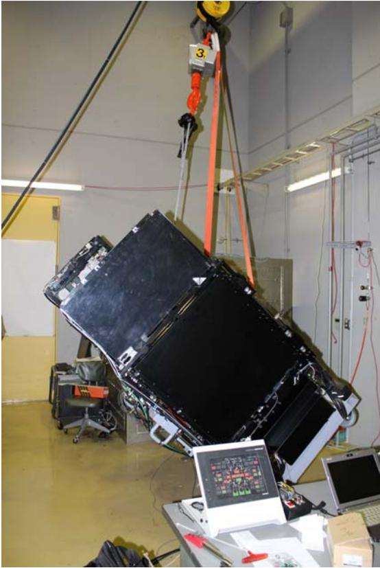
圖 二十二、濾鏡轉換機構吊掛
