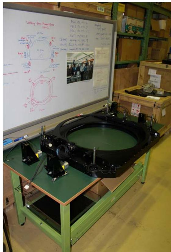
圖 二十五、濾鏡架拆下後清潔
