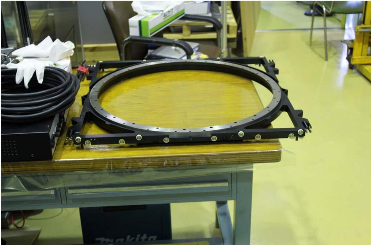
圖 十八、拆除假濾鏡後之濾鏡架
