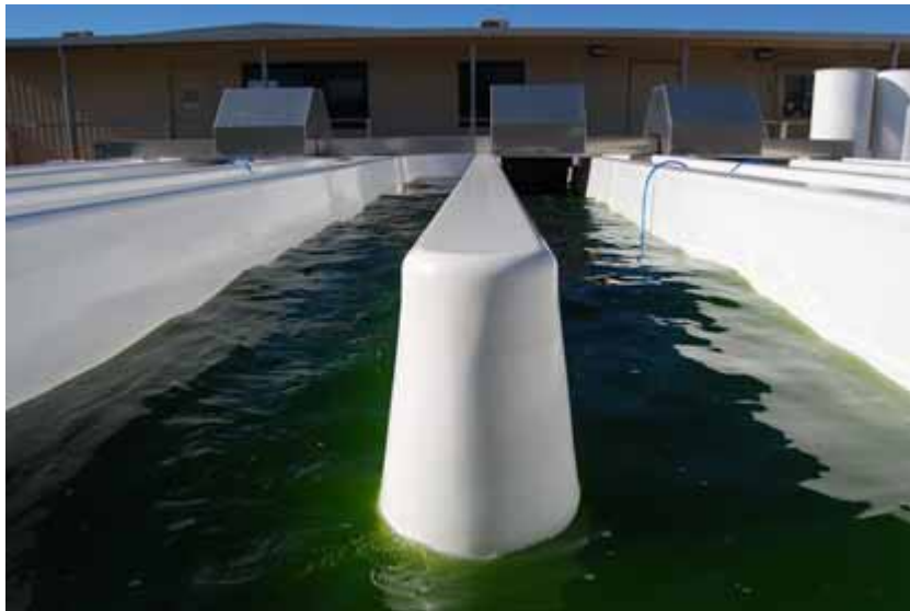
圖 c、SARDI 所建構之光反應器和露天培養池
