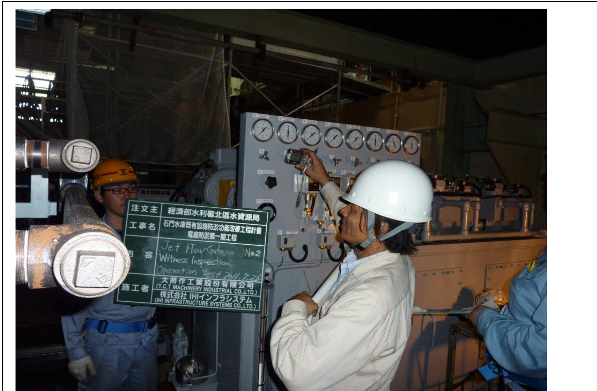
07/26 No.2 射流閘門功能試驗，測試結果符合
