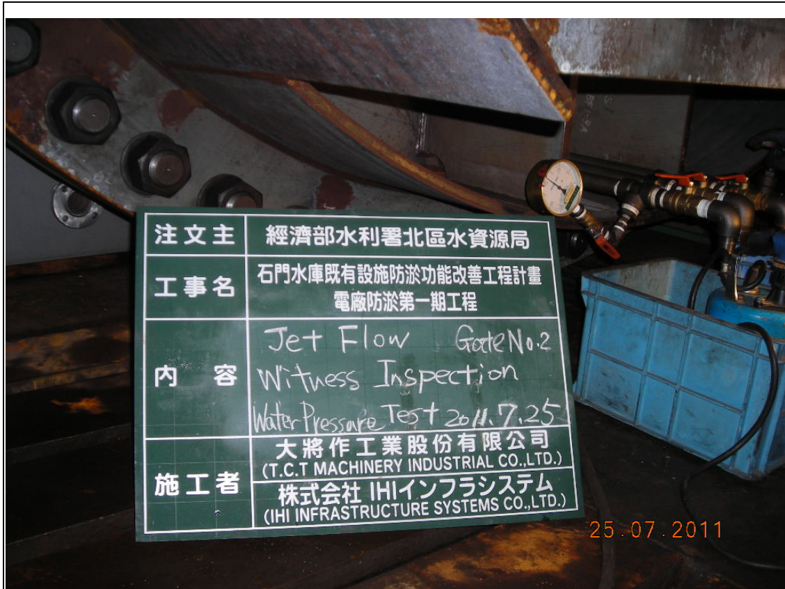
07/25 No.2 射流閘門水壓試驗，測試條件:1.64Mpa 持續 10 分鐘，測試結果無洩漏
