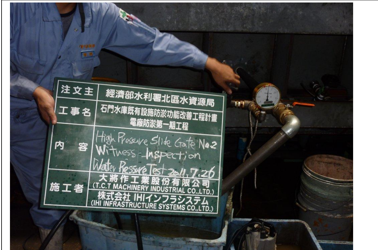
07/26 No.2 高壓滑動閘門水壓試驗，測試條件:1.64Mpa 持續 10 分鐘，測試結果無洩漏
