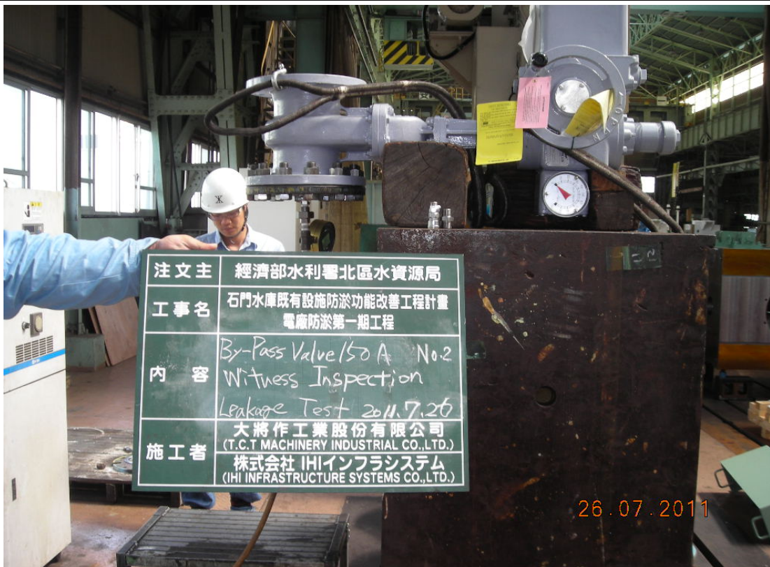
07/26 150A 旁通閘試漏，測試結果符合
