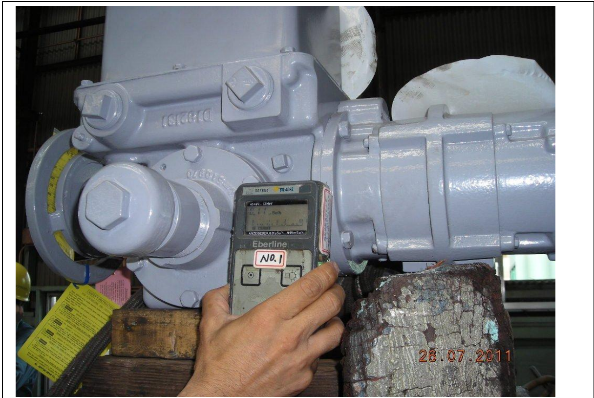
無輻射偵測結果約 0.05-0.16usv 低於標準 0.2 usv
