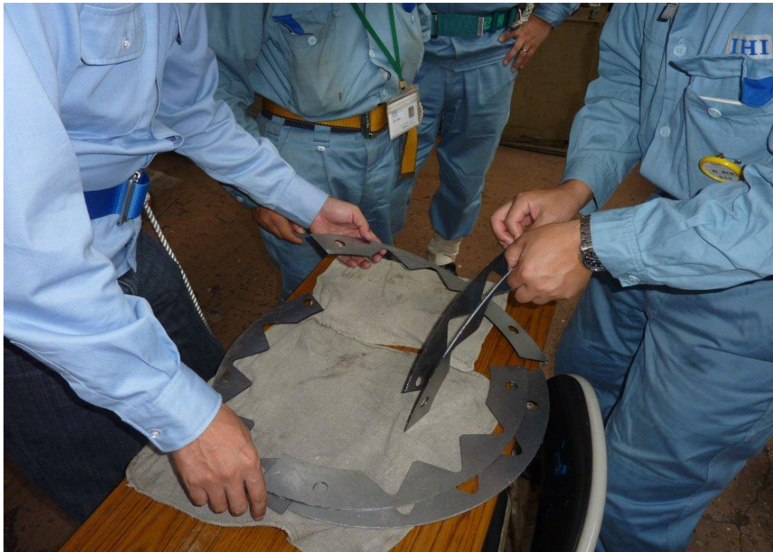
No.2 JFG 及 No.2 HPSG 油壓缸油漬滲出現象，將墊片移除 2MM 後已無油漬滲出情形。
