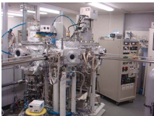
圖十四-Cluster System 的濺鍍設備
