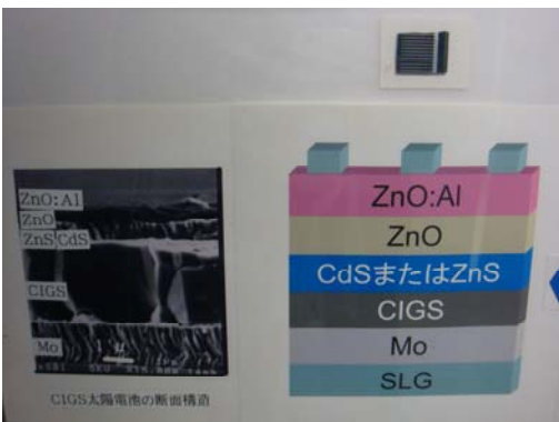
圖十三-Al 上電極層與元件剖面結構圖
