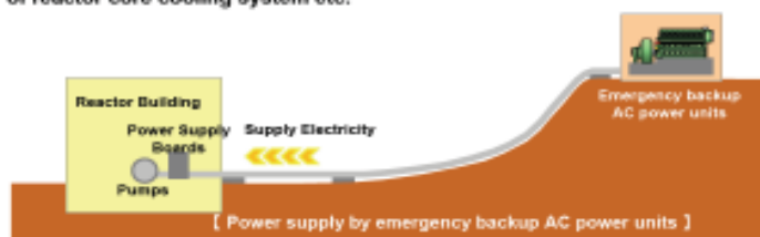
圖18 安裝備用緊急交流發電機(氣渦輪發電機)避免海嘯襲擊
